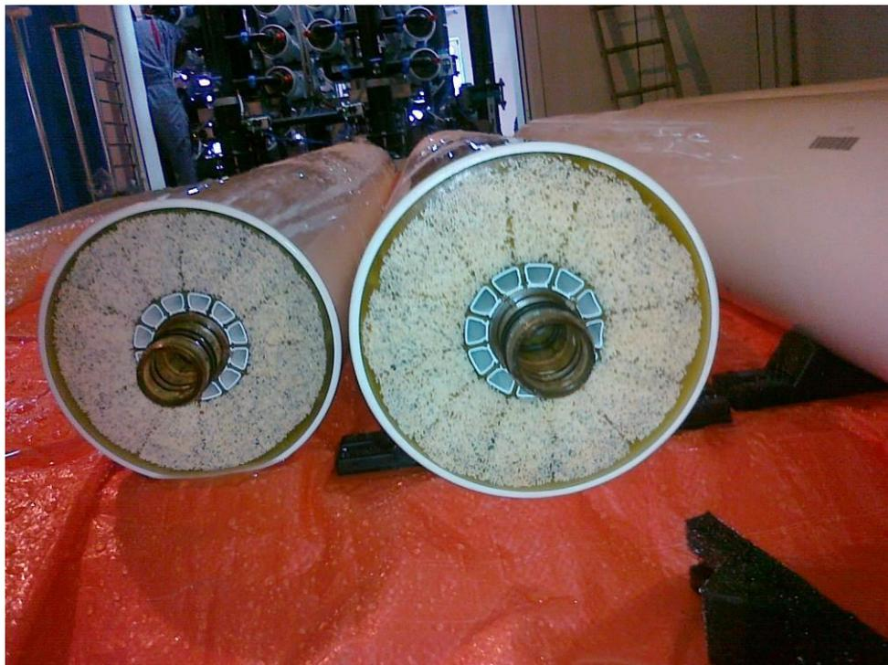
Slika 12: Modulni sistem UF naprave
