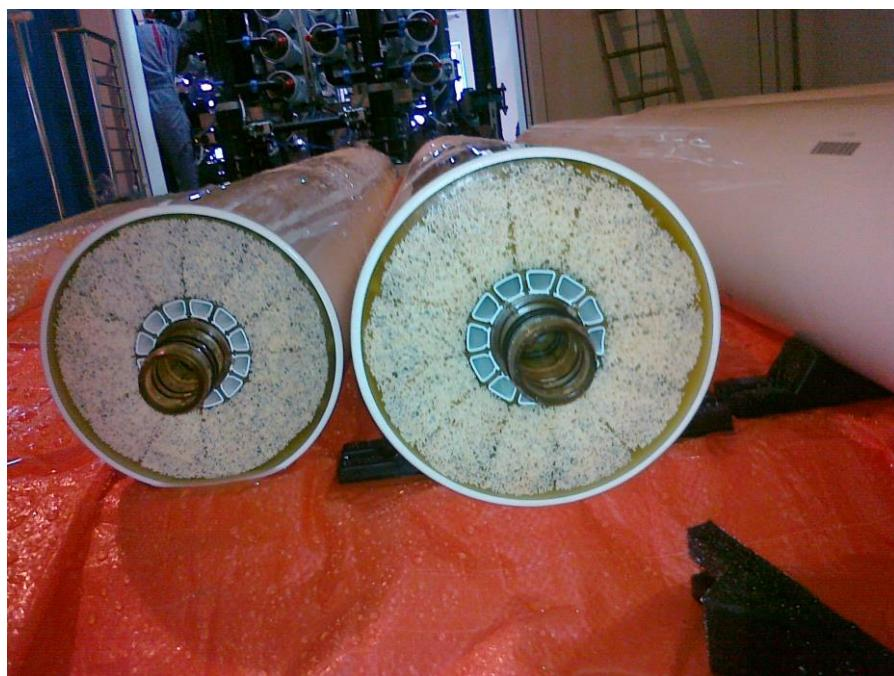
**Slika 19:** Modulni sistem UF naprave
